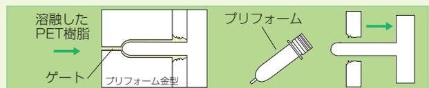
【図1】 射出成形によるプリフォームの製造
